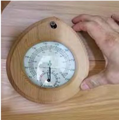
Si commandé, installez le thermomètre centré au-dessus de la porte à l'aide d'une vis de 1 ½" (38 mm).
