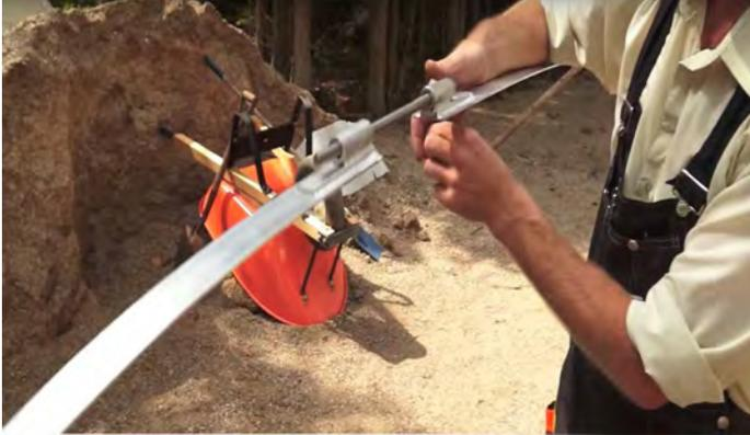
Assemblez les bandes d'acier en glissant la tige avec un écrou à une extrémité dans l'autre et en la fixant avec un deuxième écrou.
