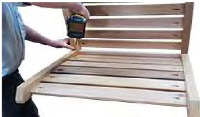
Sur une surface plane et propre, assemblez le banc de porche et l'enceinte de la paroi avant à l'aide de vis de 2 ½" (64 mm) dans les trous de poche pré-perçés.
